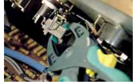
s dlouhými, špičatými upínacími čelistmi, optimální pro upnutí v úzkých mezerách
