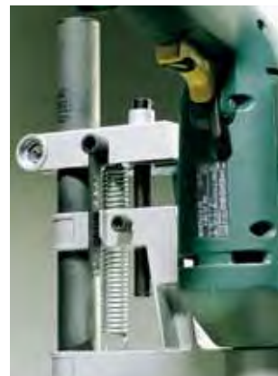
nastavení hloubky vrtání pomocí hloubkového dorazu
