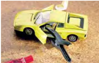
dlouhé, úzké čelisti, ideální pro dosažení těžce dostupných míst
