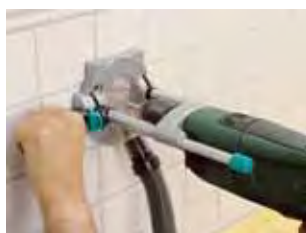
dodatečné držadlo pro přesné nasazení a proti uklouznutí při vrtáku
