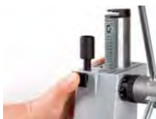
nastavení hloubky pomocí hloubkového dorazu s rychlým přestavením
