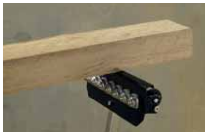
pevná dosedací plocha slouží jako prodloužení dosedací plochy pracovního stolu a jako podpora dlouhých obrobků
